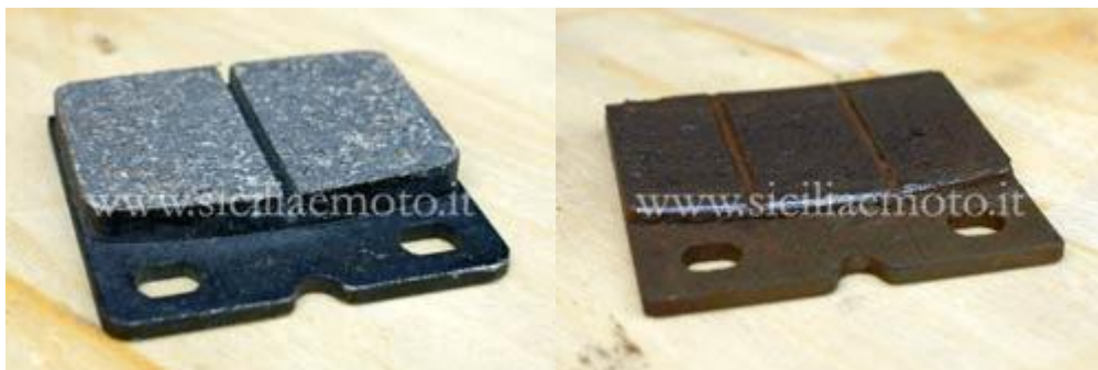
A confronto una pastiglia nuova e una ormai consumata. Si noti la differente profondità delle scanalature nel ferodo.
